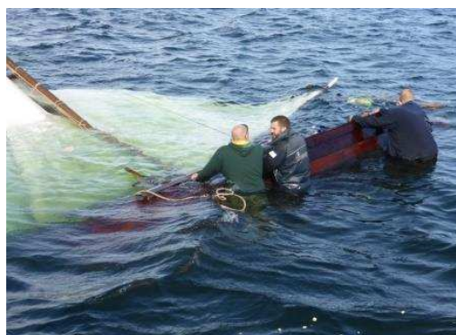
Fasta skot vid sidvind kan segla in vatten och båten lägger sig på sida.
